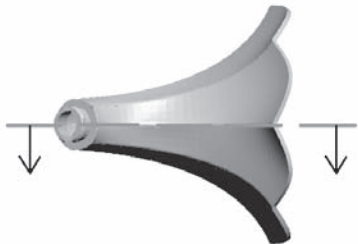
图11 分型面位置的确定
