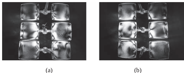
图7 不同注塑压力条件下的PC镜片内应力条纹分布图
