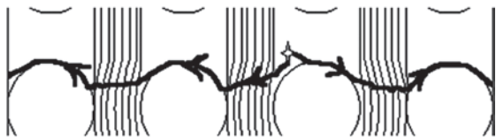
图3 X/Y向压缩时裂纹扩展示意图
