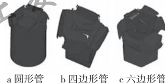
图6 不同截面形状复合材料管准静态压溃
