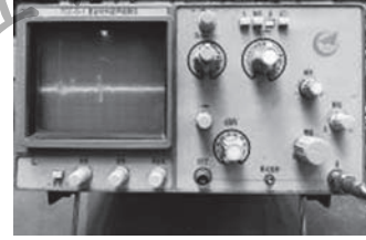
图 4 FCC-B-1 超声检测仪
