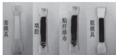
图2 试件的制作与胶层控制过程
