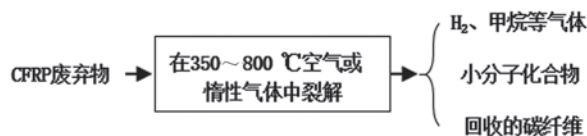
图2 高温热解法回收 CFRP 废弃物示意图
