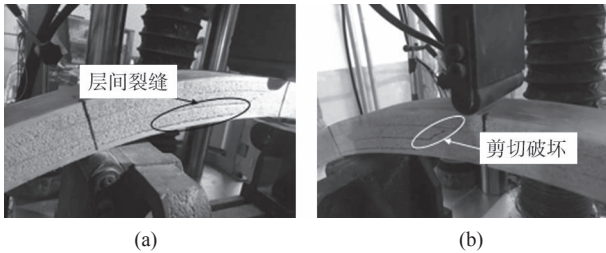
a—一层间细小裂缝; b—夹砂层剪切破坏
