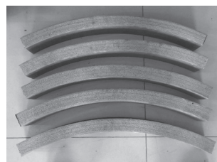
图 1 玻璃钢夹砂管管材弯曲性能测试试样
