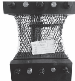
图1 PE-HD 植被网的单次试验纵向拉伸
