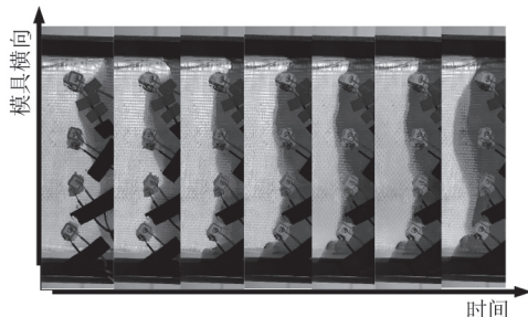
图 5 不同转角方形压电晶片实时流量前锋流向监测
