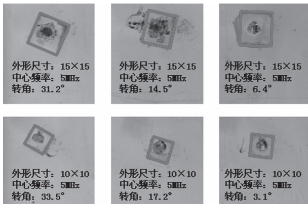
图 4 部分实验方形压电晶片布置图 (模具厚度 10 mm)
