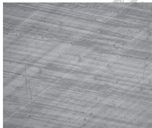
图2 BMI/CF复合非金属油管外表面的光学显微镜照片(放大400倍)
