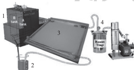
1—树脂计量和混合单元; 2—树脂缓冲装置; 3—模具和加热系统; 4—压力控制系统
