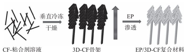
图2 冻干取向法制备 EP/CF 三维导热复合材料示意图
