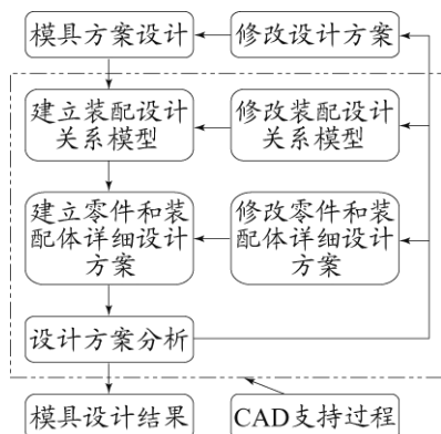
图 2 Top-Down 模具设计流程图
