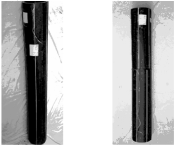
图6 止裂的裂纹 图7 扩展的裂纹
