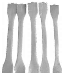
图 3 加入 MPP 的 SGF 增强 PA66 试样水解后的照片
