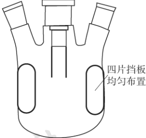
图 3 4 口带有挡板的圆烧瓶示意图
