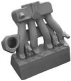
图 2 发动机歧管 PS 树脂模具
