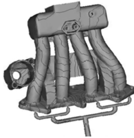
图7 充填时间 3.9 s 时的熔体等温曲线
