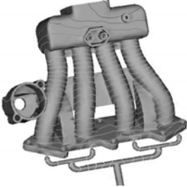
图5 充填时间 3.9 s 时的熔体等压曲线
