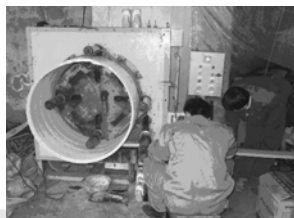
图 2 用专用缠绕机缠绕管材
