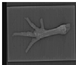
图 6 纳米铈增感屏上鸡爪子的 CT 图像
