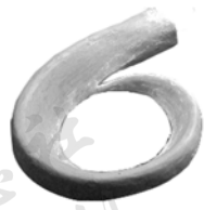
图 5 快速原型制造技术制备的管道实体模型
