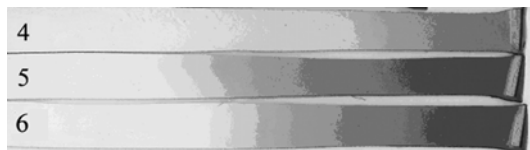
图2 不同异型材的连续烘箱试验结果
