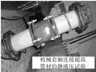
图 5 UHMWPE 管材机械式密封连接试验
