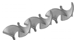
图 2 旋转式 Kenics 混合元件三维结构示意图
