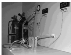
图5 燃料电池发电试验和性能测试
