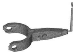
图4 浇口改进后的玻璃纤维取向图
