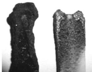
图 1 未阻燃(左)与阻燃试样(右)垂直燃烧后的照片
