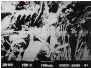
图 3 试样拉伸断口的 SEM 照片
