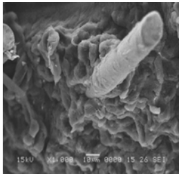
图 4 试样冲击断面的扫描电镜照片
