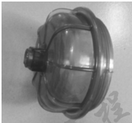
图 2 控制模具温度后的制品
