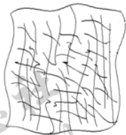
图 1 ABS/SSF 的三维导电网络结构示意图
