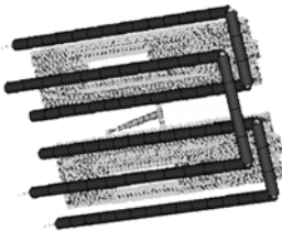
图 4 浇注系统及冷却系统设置示意图
