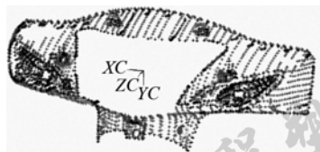
图2 多视图对齐后的挡风罩完整点云数据
