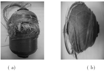
a—树脂未经纳米 SiO 2 改性; b—树脂经 3% 纳米 SiO 2 改性 图 5 水压爆破后的 150 mm 容器
