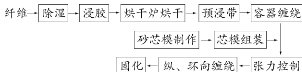
图2 150 mm 容器的制作工艺流程
