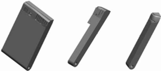
图 9 几种斜滑块结构
