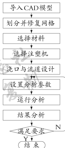
图 1 Moldflow 分析流程图
