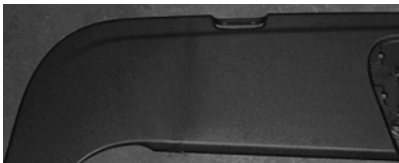
图9 工艺调整后的注塑效果
