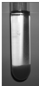
图2 原位插层 SMAH/MMT 纳米复合材料的 Molau 实验图
