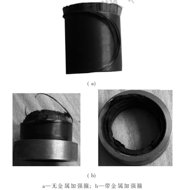
图 6 不同端部结构的复合材料管的破坏形貌 实验中发现端部不带金属加强箍的复合材料试件首先在端部受到破坏, 随着载荷的增加, 端部裂纹不断扩展, 产生周向分布的多条裂纹, 使复合材料管壁分裂成多瓣, 直至端部失稳破坏; 而带金属加强箍
