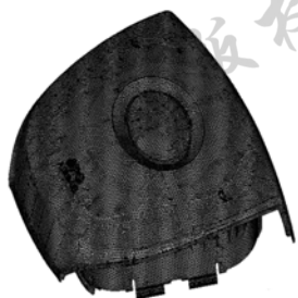
图 2 注塑件的有限元模型
