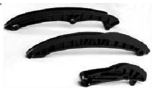
图8 采用优化注塑工艺参数生产的塑料件
