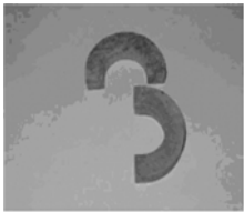
图 5 失芯材料制备的半圆型型芯
