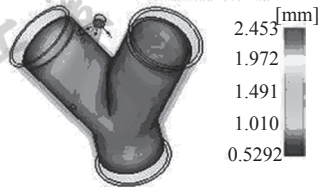
图8 原始方案收缩引起的变形
