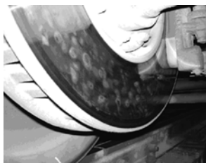
图7 对照闸片配对制动盘表面的典型状况
