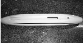
图 4 用增强耐磨 PA66 复合材料制得的织布梭
