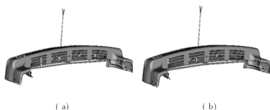
a—普通注射成型; b—顺序注射成型
