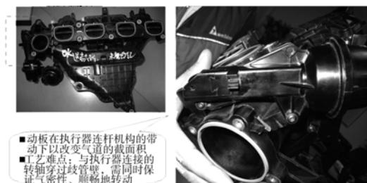
图7 可变截面型(带动板)进气歧管的质量控制
