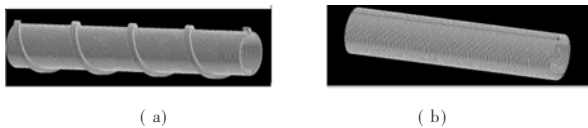
a—螺杆计量段; b—流道 图 1 螺杆和流道模型
