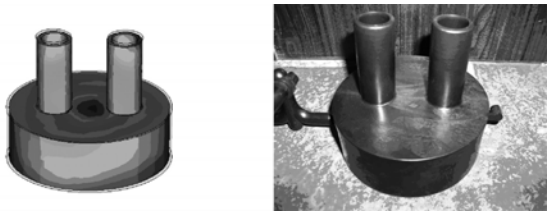
(a) (b) a—模拟结果; b—实际试模结果
