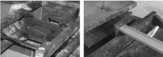
(a) (b) a—导向滑口和嵌板的安装; b—牵引 图 3 生产现场
